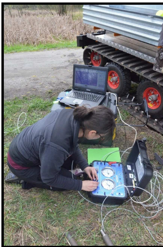
Fotografia 5. Badanie dylatometrem (fot. Marta Chada)
