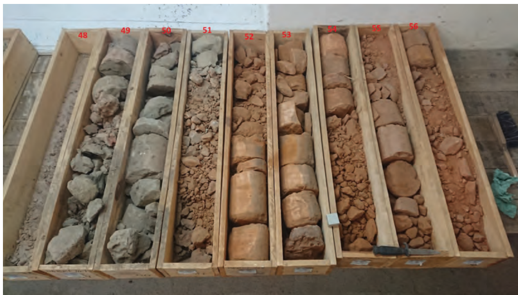
Fot. 2. Skrzynki z rdzeniem wiertniczym z otworu Dębki IG 1 (otw. 4), z którego pobrano próbki do badań. Na głębokości 316,4–322,9 m (skrzynki 49–51) rozpoznano gliny zwałowe z domieszką żwirów skał skandynawskich, a poniżej (skrzynki 51–56) ceglasto-czerwone piaski z przewarstwieniami piaskowców triasu dolnego (pstry piaskowiec środkowy) – formacja pomorska (Wagner, red., 2008) (fot. K. Wirkus, 2018)
